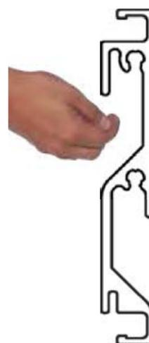
Mittelsprosse mit integrierter Griffleiste
