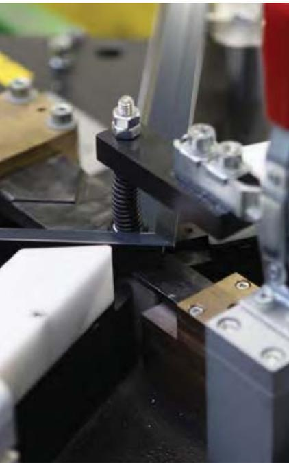
Eckverpressung mit 8 bar Luftdruck
